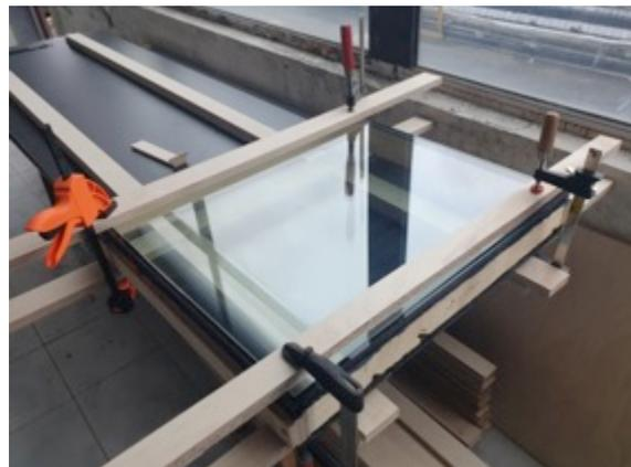
L'approvisionnement en double-vitrage de réemploi a été plus difficile que prévu. La caractérisation des vitrages pourra être améliorée ( $U_w$ , facteur solaire, surfaces émissives, etc). Un important stock - qualifié au préalable - serait nécessaire pour déployer ce réemploi selon les délais standard de livraison du bâtiment.
